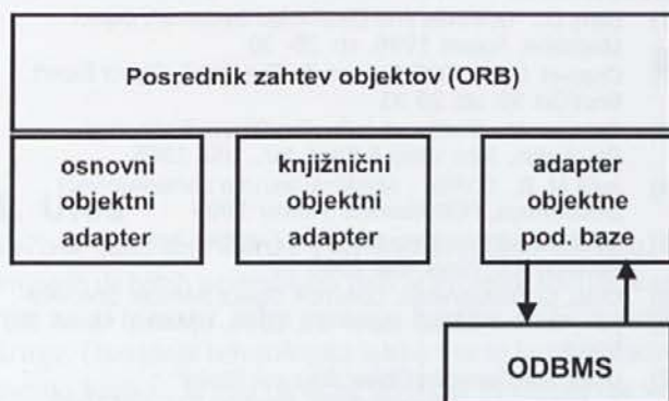
Slika 5: ODBMS kot upravitelj objektov znotraj OMG arhitekture
