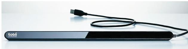
Slika 4: Sistem za spremljanje očesnih gibov Tobii Eye Tracker 4C. (Slika je povzeta s spletnne strani [www.tobii.com](http://www.tobii.com).)
