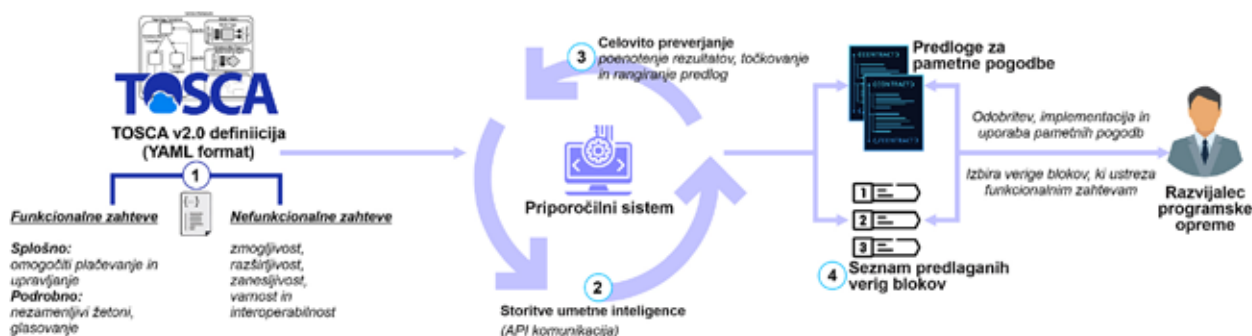
Slika 2: Nadgrajena arhitektura priporočilnega sistema pametnih pogodb na podlagi nefunkcionalnih zahtev kot vhodnega podatka sistema vrne seznam predlaganih verig blokov.
