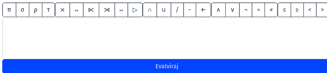
Slika 4: Vnosno polje za zapis izrazov v predstavljenem orodju. Nad vnosnim poljem imamo gumb za zapis operacij relacijske algebre.
